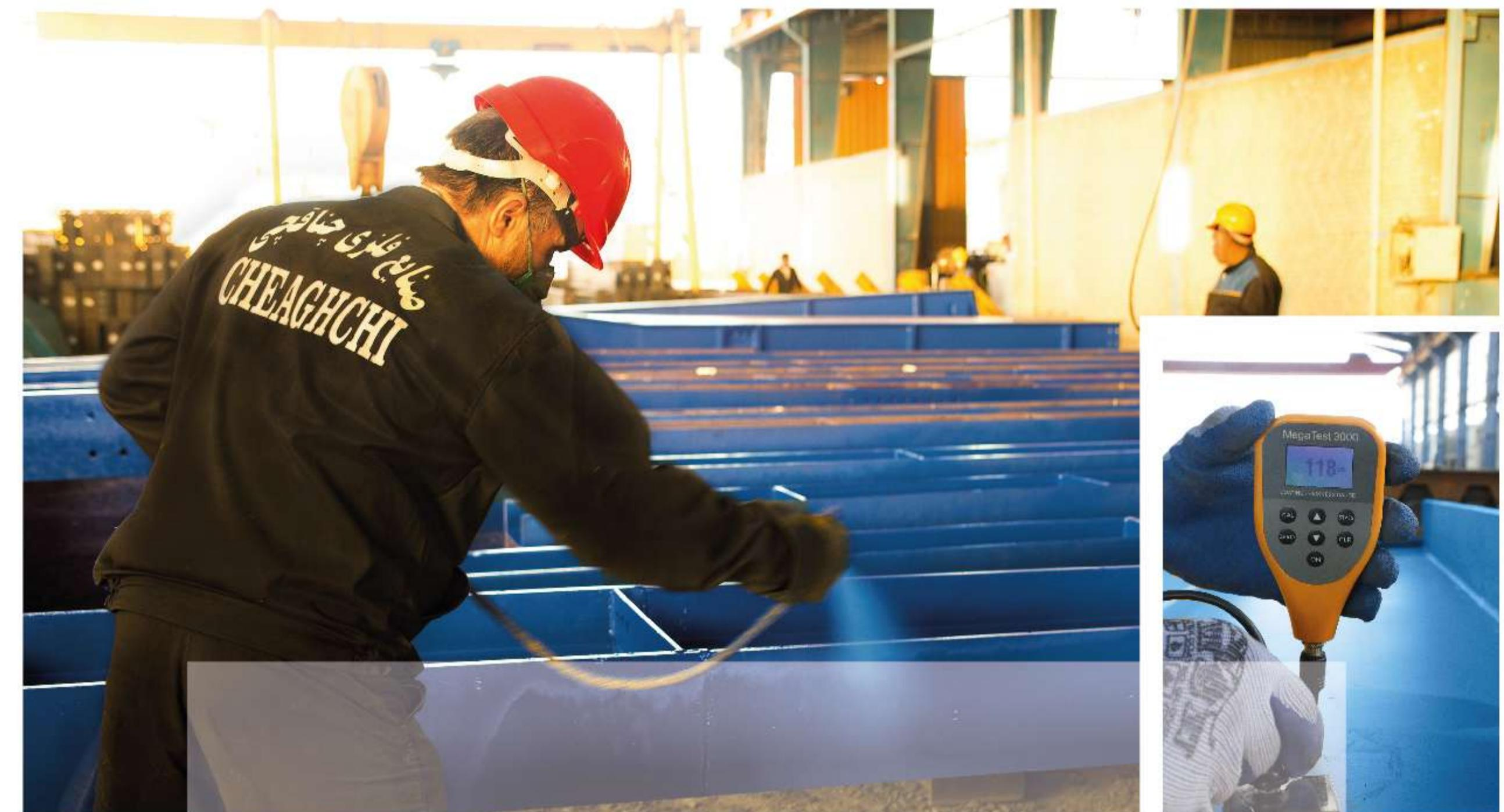
قطعات تمیز شده این بار به واحد Shot Blast یا Sand Blast منتقل شده و وفق مشخصات فنی منضم به قرارداد با پاشیدن ماسه سیلیسی یا ساجمه های آهنی هرگونه آلایش چسبیده بر روی آهن و قابل زدودن از سطح آن پاک می شود. و قطعه تمیز شده در این واحد می بایست در اسرع وقت به کارگاه نقاشی منتقل شده و رنگ های مختلف به مشخصات فنی لازم در محیط عاری از هرگونه گرد و غبار بر روی قطعه پاشیده شود.
